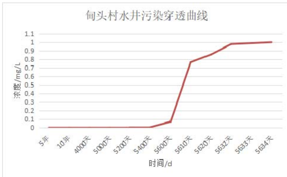
图 6.5-8 甸头村水井污染穿透曲线图
