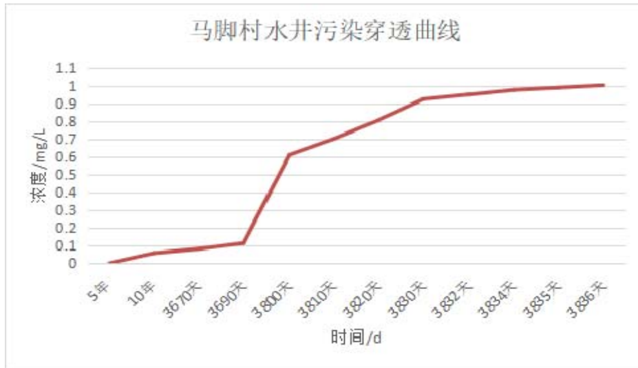
图 6.5-7 马脚村水井污染穿透曲线图
